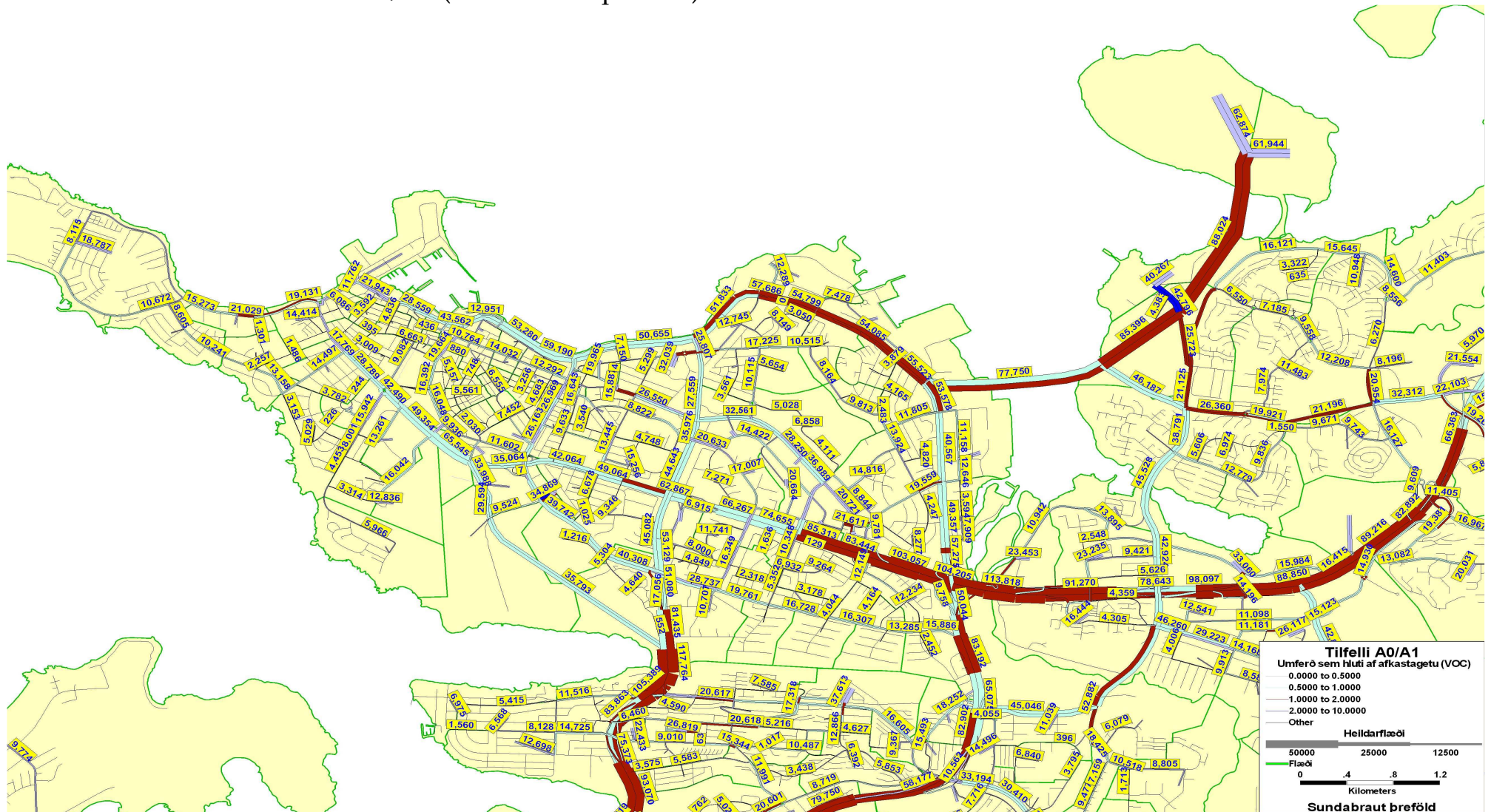
Kostir A0/A1: Heildarflæði og umferð sem hlutfall af afkastagetu (VOC), Sundabraut þreföld.
