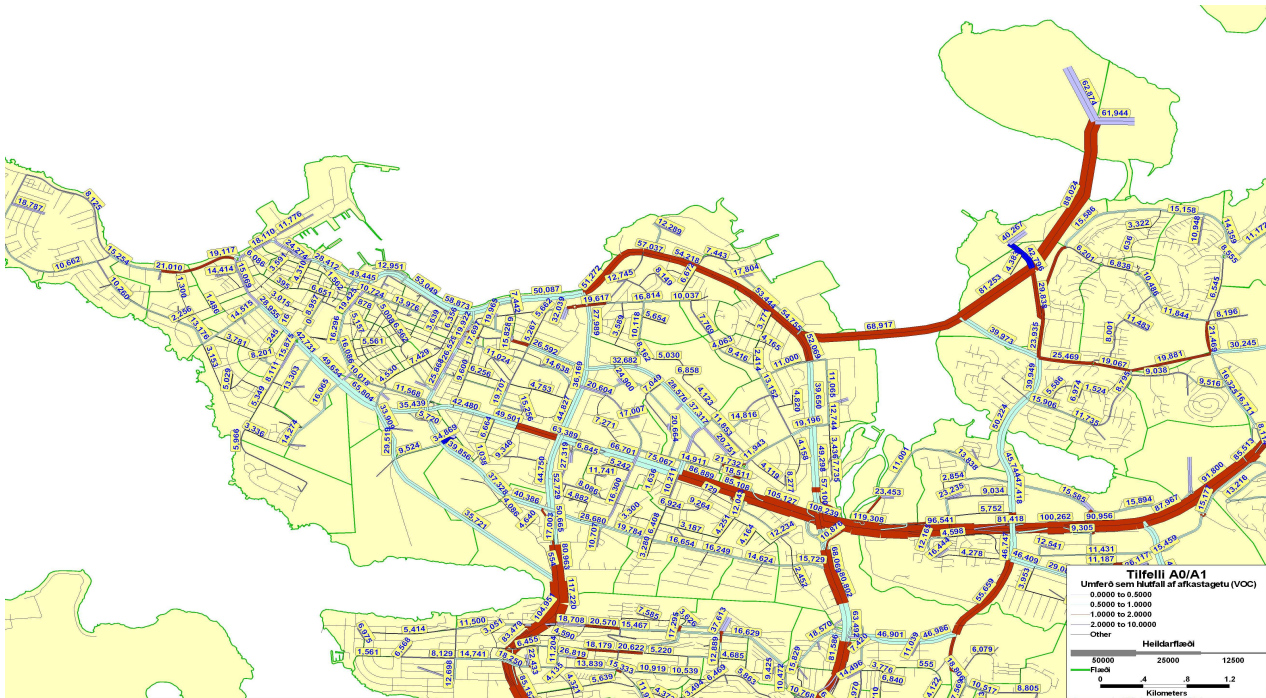
Mynd 5-7. Kostir A0/A1: Heildarflæði og umferð sem hlutfall af afkastagetu (VOC), Sundabraut tvöföld.
