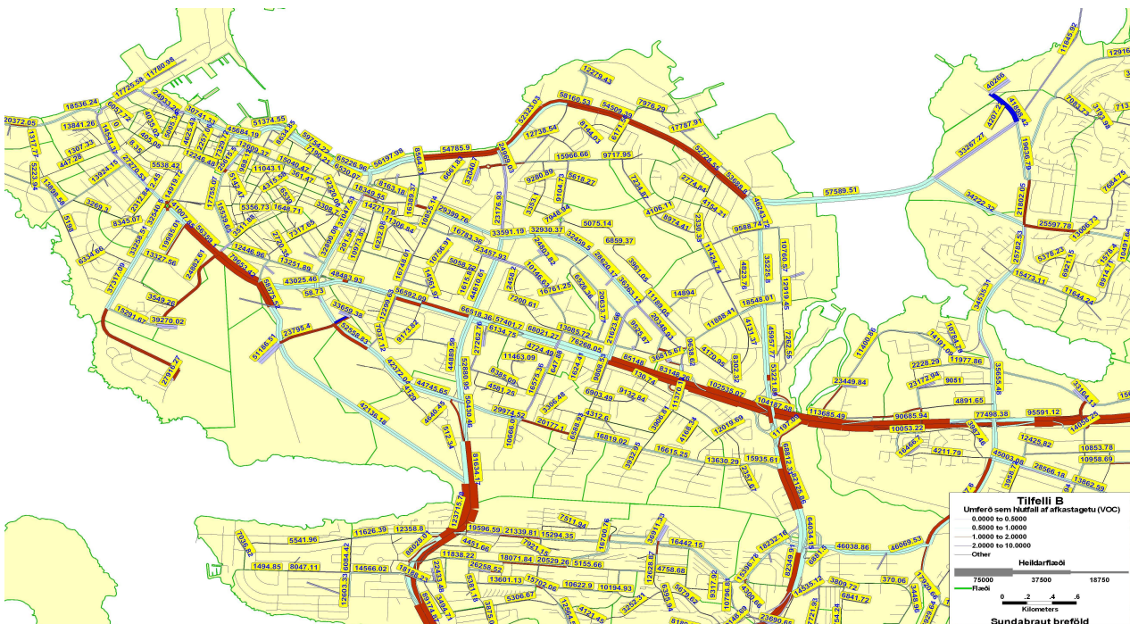
Mynd 5-12. Kostir B: Heildarflæði og umferð sem hlutfall af afkastagetu (VOC), Sundabraut þreföld (sjá stærri mynd í viðauka).
